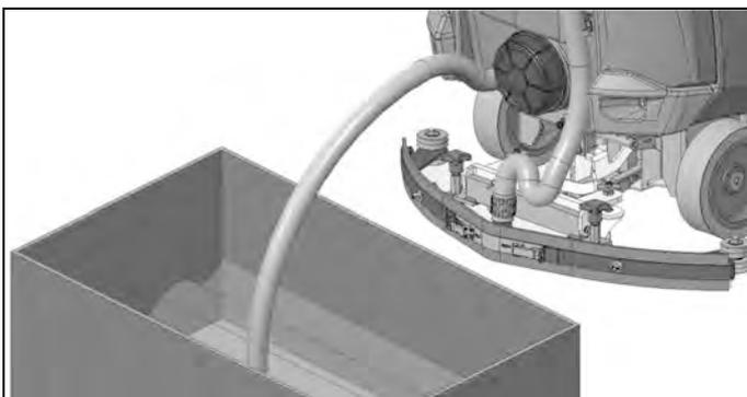
3. Nachdem der Tank vollständig entleert wurde, den Ablaufschieber (1) durch Lösen des Hebels (2) entfernen und den Deckel (3) losschrauben.
