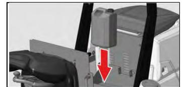
Den Deckel des Behälters entfernen und ihn mit dem Anpassungsstück ersetzen. Der Schlauch muss den Behälterboden berühren.
