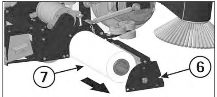
11. Wenn die Walze wieder montiert wird, diese in das Gehäuse einfügen, wo die Walze einen tieferen Sitz hat. Die andere Seite muss gegen die Halterungsplatte montiert sein.
