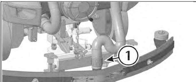
2. Den Schlauch inwendig mit einem Wasserstrahl waschen.
