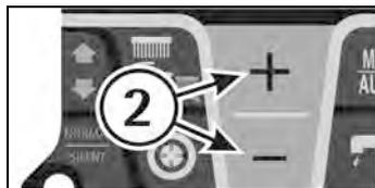
Nach einigen Sekunden hört der Wert auf zu blinken und die Reinigungsmittelmenge ist gewählt. Beim Wert 0% wird nur Wasser zum Reinigen verwendet.
