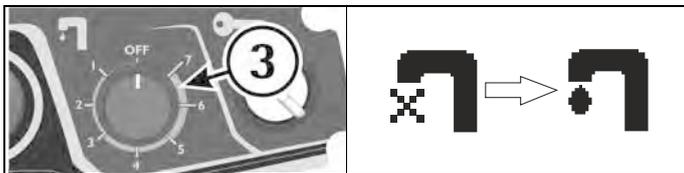
4. Das Bürstengehäuse durch Drücken der Taste (4) auf den Boden senken; das Display visualisiert zuerst das Symbol der Senkung und danach die Betätigung der Bürstenmotore, die sich mit der Fahrfunktion aktivieren.
