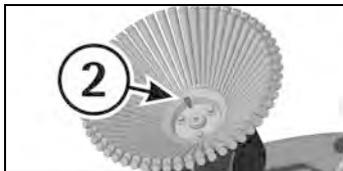
Um die Bürste wieder zu montieren, die Schraube (2) gut anziehen.
