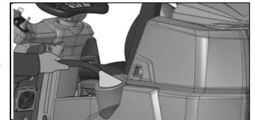
6. Mit einem Wasserstrahl die Filterteile spülen.
