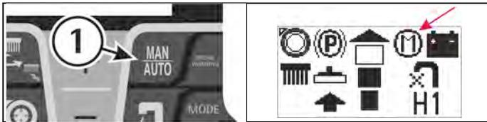
2. Die Taste des Saugmotors (2) drücken; das Symbol des Saugmotors ändert von ausgeschaltet auf eingeschaltet und der Saugmotor beginnt abzusaugen.
