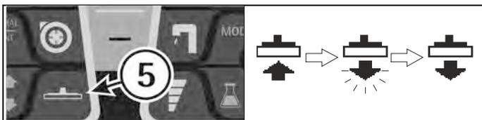
6. Während den ersten Metern kontrollieren, dass die Saugfußregulierung eine perfekte Trocknung garantiert und dass die Regulierung der Frischwassermenge ausreichend ist. Sie muss genügend sein, um den Boden regelmäßig zu benetzen, aber nicht zu viel, dass sie vom Spritzgummi ausfließt. Man soll jedoch bedenken, dass die richtige Frischwassermenge immer je nach Bodenart, Hartnäckigkeit des Schmutzes und Geschwindigkeit abhängt.
