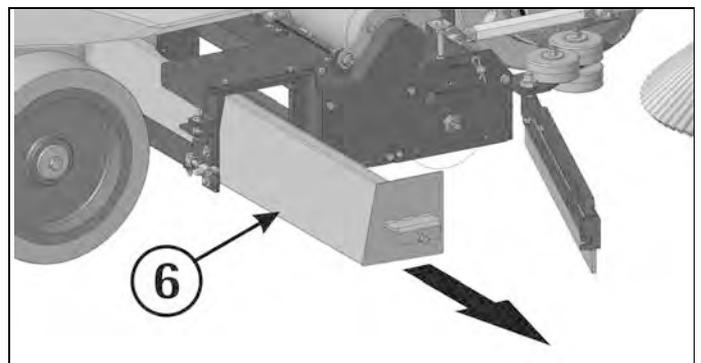
10. Den Sammelbehälter in geeignete Becken entleeren, gemäß den gültigen Normen für die Schmutzentsorgung.
