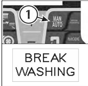
Auf diese Weise heben sich die Bürsten automatisch, die drehen, um zu trocknen, das Magnetventil schließt sich und man kann die Trocknung in etwa 15 Sekunden beenden, danach hebt der Saugfuß komplett an und der Saugmotor stoppt.
