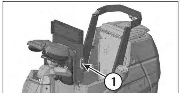
Ist die Maschine mit dem optionalen 3SD-Wassersystem ausgestattet, muss die Halterung der Reinigungsmittelbehälter entfernt werden, nachdem man die Sitzfläche angehoben hat. Um die Halterung zu entfernen, die 6 Befestigungsschrauben lösen.
