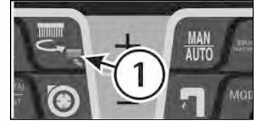
Auf dem Display blinkt der eingestellte Wert. Die Taste (-) drücken um den tieferen Druck zu wählen: am Ende des Blinkens ist der Wert eingestellt.
