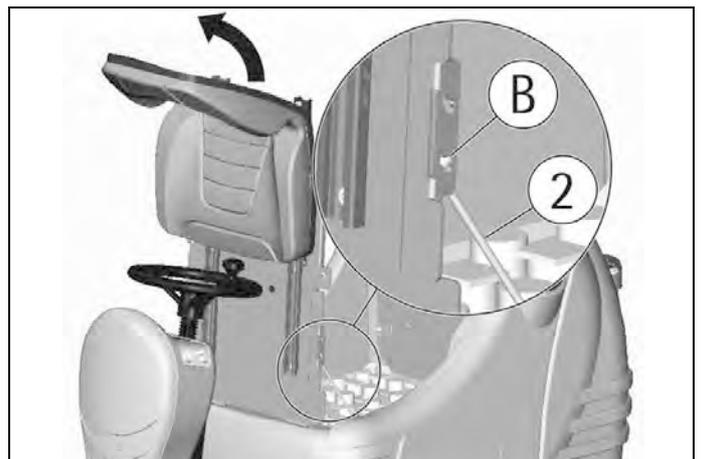
Auf diese Weise ist es möglich, die Batterien mit geeigneten Hebegeräten zu manövrieren.
