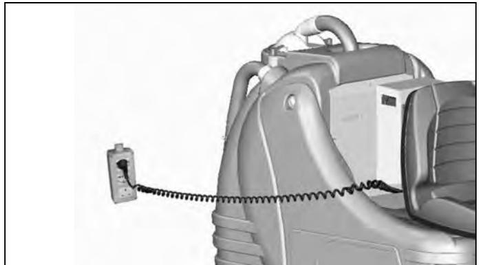
**Niemals eine GEL-Batterie mit einem nicht geeigneten Ladegerät laden. Die Anweisungen des Batterie- und Ladegerätherstellers strikt folgen.**
