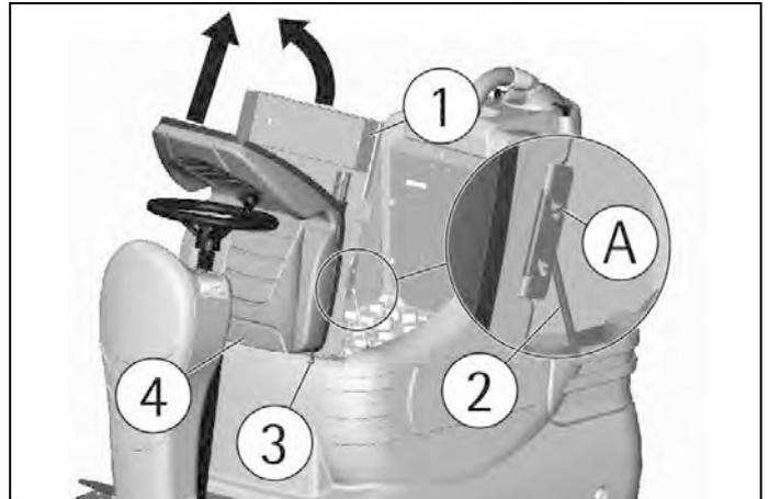
4. Den Sitzträger weiter nach vorne kippen, bis der Kipphebel (2) in Position B einrastet.
