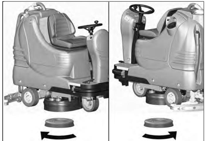
Man rät zur täglichen Umkehrung der Bürsten, um eine längere Lebensdauer zu garantieren. Sollten die Bürsten unvermeidbar verformt sein, raten wir, sie in derselben Position wieder zu montieren, um zu vermeiden, dass die diverse Neigung der Borsten eine Überlastung des Motors oder unangenehme Vibrationen verursacht.
