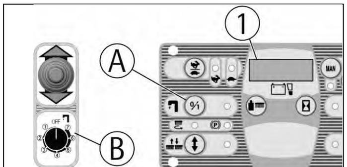
Ist der Drehschalter (B) in OFF-Position, kann man in traditioneller Weise arbeiten, d.h. Frischwassertank mit Wasser und Reinigungsmittel. In diesem Fall ist es notwendig, den Wasserhahn (C), der sich unter der Maschine befindet, manuell zu öffnen und zu
