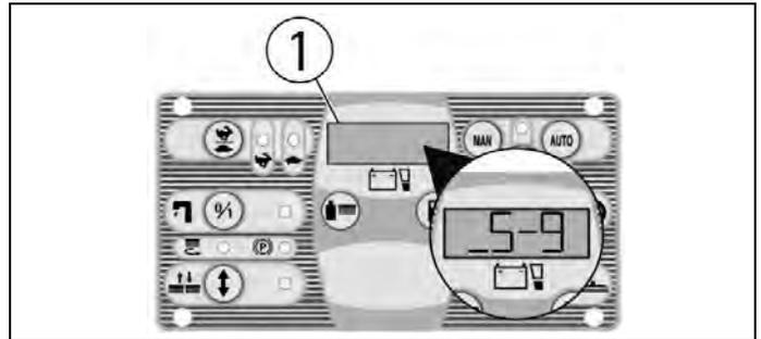
4. Der Batterieladeanzeiger ist digital. Dieser bleibt ständig auf dem Display. Der Stand der Batterieladung beginnt mit -100-, was der Höchststand (100%) ist, mit einer Reduktion von jeweils 10. Ist der Ladungsstand bei -20-, beginnt das Display zu blinken und man ist kurz vor Arbeitsende.
